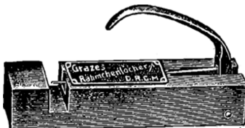
Graze's gaatjesapparaat (voor het ponsen van gaatjes in de raamlatjes).
